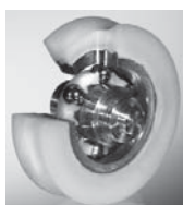
60.5050 Løberulle med stål kugleleje betrukket med nylonkappe. 2 stk. max 25 kg, 4 stk. max. 50 kg. glas.
