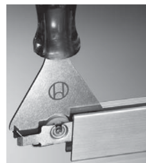
Special nøgle til isættelse af løberullen i løbeskopprofilen
